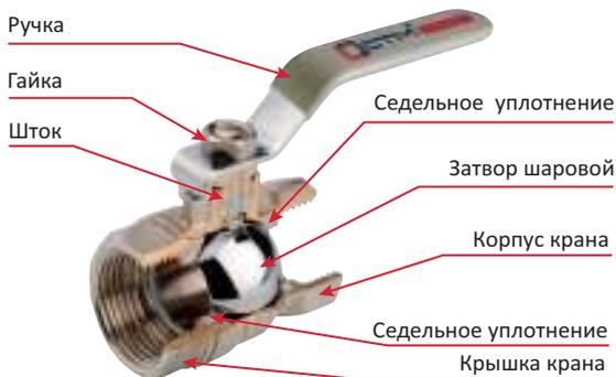
Кран шаровой для воды, внутренняя резьба, ручка-рычаг
